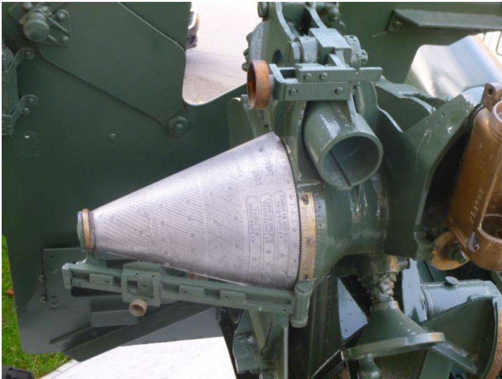
*Figure 18: Elevation System, author's own photo, Nov. 2, 2022*
